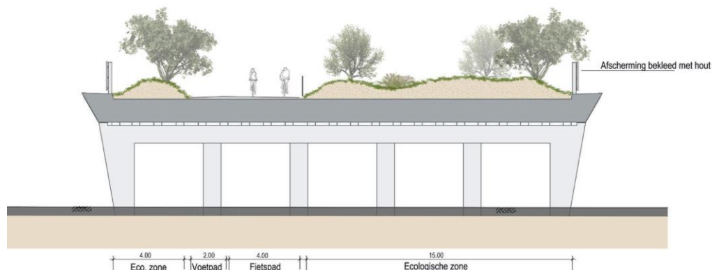
Afbeelding 14 Dwarsdoorsnede nieuwe ecorecreeaduct bij Nimmerdor, bron: Landschapsplan
