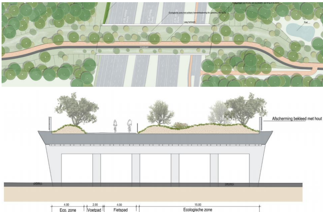
Afbeelding 31 Ontwerpschets van het ecorecreaduct Paradijsweg met bovenaanzicht (boven) en dwarsprofiel (onder). Zie Landschapsplan voor meer gedetailleerde weergave.
