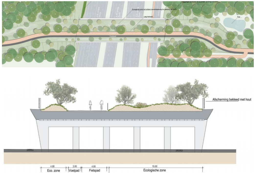
Abbeiding 7 Ontwerpschets van het ecorecreaduct Paradijsweg met bovenaanzicht (boven) en dwarsprofiel (onder). Zie Landschapsplan voor meer gedetailleerde weergave
